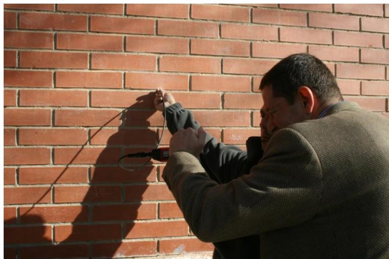
Medición de espesor de cámara de aire y análisis con cámara endoscópica
